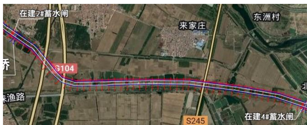
图 2-6 茨州泵站～4#蓄水闸段河道扩挖示意图
